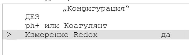
Это меню высвечивается, если настроена конфигурация „Свободный хлор“. Пользователь имеет возможность дополнительно настроить измерение и индицирование показателя Redox. При этом функция регулирования Redox отсутствует.
