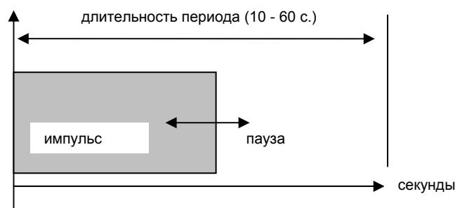
Мощность дозирования подключенного насоса есть линейный результат, полученный из соотношения Длина импульса (пульсации) – Пауза коммутационного положения реле. Длительность периода определяется как временной интервал между моментами замыкания контактов, а длина импульса – как время пребывания контактов в замкнутом состоянии. Минимальная длина импульса (мин. импульс) составляет 2 с., максимальная – 60 с.
