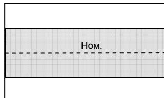
Вокруг номинального значения создается виртуальный диапазон регулирования, т.н. Р-диапазон. Если измеряемое значение находится вне Р-диапазона, то мощность дозирования составляет 100%. Если измеряемое значение выходит за рамки Р-диапазона, объем дозирования сокращается пропорционально этому диапазону вплоть до полного ее прекращения при достижении номинального значения.
