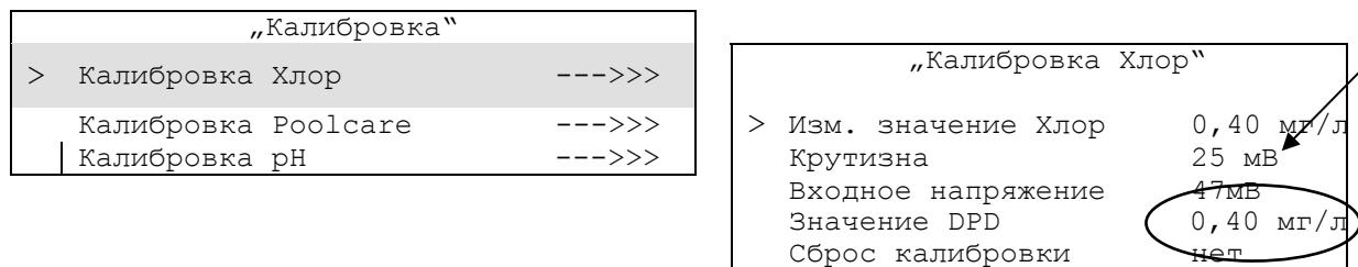
Это значение принимается к действию с небольшой задержкой. На этом калибровка хлорного электрода считается завершенной. Крутизна электрода рассчитывается автоматически и отображается на дисплее.
